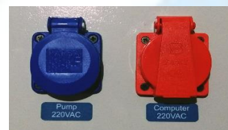
محل اتصال کابل کامپیوتر و پمپ خلا
